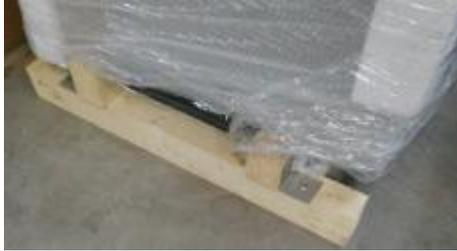
Para una eventual manipulación en el puesto de instalación (colocación precisa) se puede utilizar una carretilla por el lado sin que sean necesarios los refuerzos. La carretilla debe tener la longitud suficiente para soportar las dos patas.
