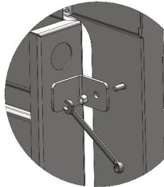
Primero levantar moderadamente la cubierta superior del panel de control en el lado trasero (una elevación excesiva puede ocasionar un daño del borde delantero de la cubierta) y mover hacia sí. Después quitar la cubierta delantera y lateral. Destornillar la escuadra de seguridad del distribuidor.
