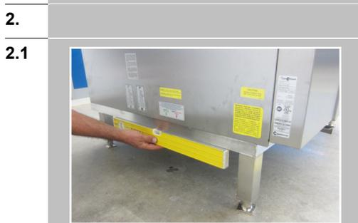
**Mettre à l'horizontal le niveau A (côté gauche)**
