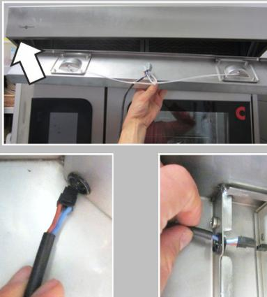
Pase el cable de conexión de la iluminación por los dos pasajes situados a la izquierda debajo de la campana de condensación.
