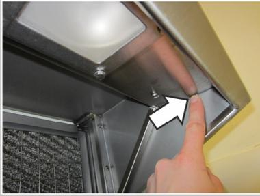
Compruebe si la chapa de ajuste toca la pared exterior de la campana de condensación y, dado el caso, reajuste la chapa.
