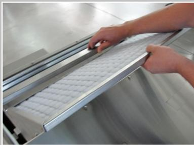
Levante el marco de soporte del separador de vapor con ayuda del tirador empotrado negro y extraiga el separador de vapor hacia delante.
