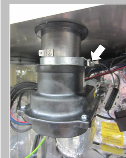
Afloje el tornillo de la abrazadera de manguera del tubo de ventilación con una llave de vaso de tamaño 7 hasta que la abrazadera pueda pasarse por encima del conector plano.
