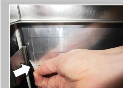
Retire la cinta adhesiva de aluminio del lado interior de la cubierta de la campana de condensación.
