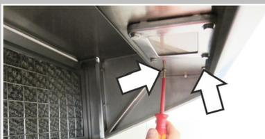
Затяните 2 крепежных винта юстировочной планки.
