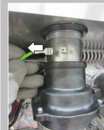
Вытяните кабель заземления из плоского штекера на вентиляционном патрубке.
