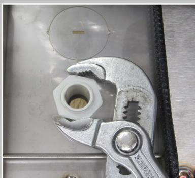
Затяните гайку резьбового соединения на противоположной стороне.
