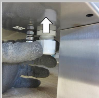
Установите резьбовое кабельное соединение M20 через отверстие.
