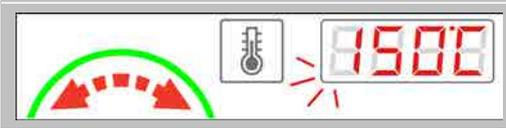
Ajuste a temperatura de cozimento girando o botão Dial C.
