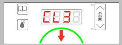
Pressione brevemente o Dial C para iniciar o processo de limpeza.
