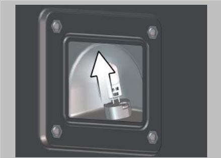
3. Tenere per l'apertura della parete della camera di cottura nell'alloggiamento del riflettore ed estrarre la lampada alogena verso l'alto.
