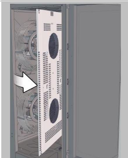
Inclinare la grata di aspirazione nella camera di cottura.
