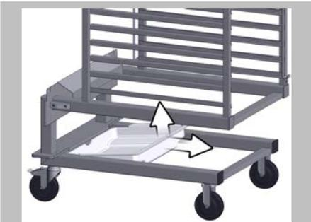
1. Desplace la bandeja recogedora de condensado un poco hacia atrás. Inclíne ligeramente la bandeja para condensado por el lado del tope para poder desplazarla hacia atrás más allá del mismo.
