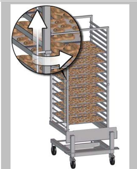
Vuelva a bloquear el tope de profundidad abierto. (En el tamaño de aparato 20.10 se suprime este paso).
