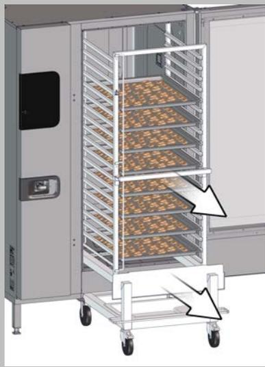
Extraiga el carro de carga por el asa de la cámara de cocción.
