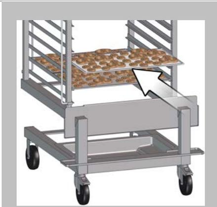
Cargue el carro de carga por delante en los tamaños de aparato 12.20 y 20.20, y por el lateral en el tamaño de aparato 20.10.
