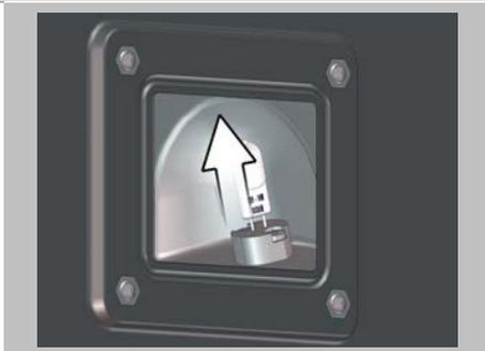
Introduzca la mano por el orificio de la pared de la cámara de cocción en la carcasa reflectora y extraiga la bombilla halógena de forma recta hacia arriba.
